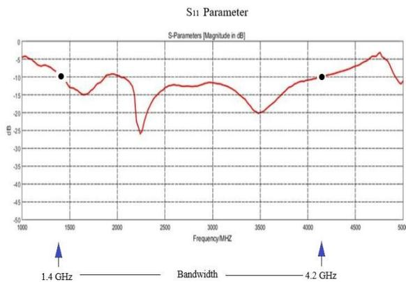
Fig. 4.  $S_{11}$  parameter simulation graphic.
